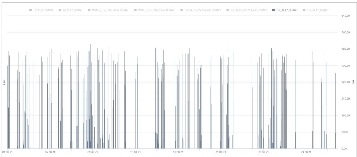
Abbildung 48: Elt. Energieverbrauch BHKW 2 (ELZ_W_EZ_BHKW2 in Wh) 15 Min.-Werte
