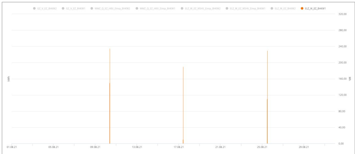
Abbildung 47: Elt. Energieverbrauch BHKW 1 (ELZ_W_EZ_BHKW1 in Wh) 15 Min.-Werte
