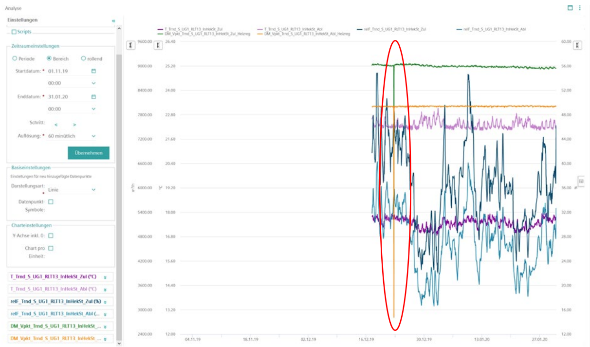
Abbildung 77: kurzfristiger Abfall des Luftvolumenstromes
