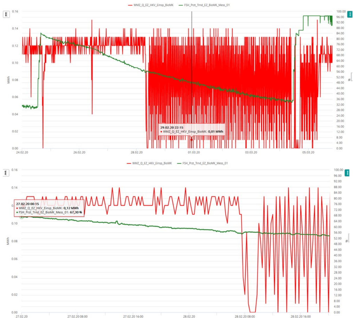
Abbildung 86: Füllstandhöhenabnahme und erzeugte Energie (verschiedene zeitliche Auflösungen)
