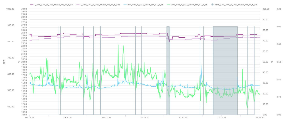
Abbildung 162: Raumlufthausqualität Musterraum „Patientenzimmer“ 41.6.58 – Winterwoche
