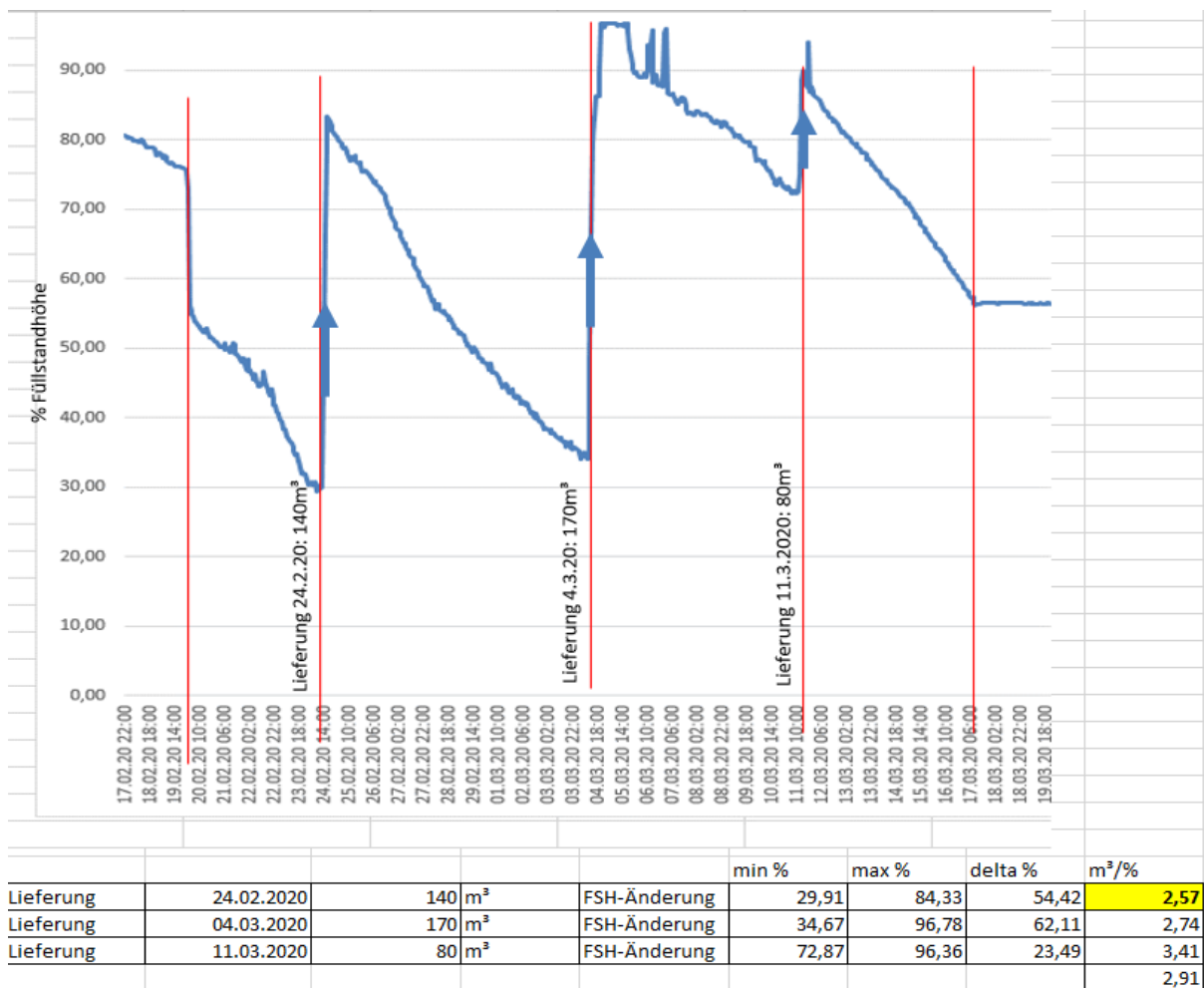
Abbildung 84: Abgleich geliefertes Volumen Hackschnitzel (Lieferscheinwerte) mit gemessenen Füllstandhöhen in %
